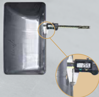
Stärke Mit Mikrometer messen
