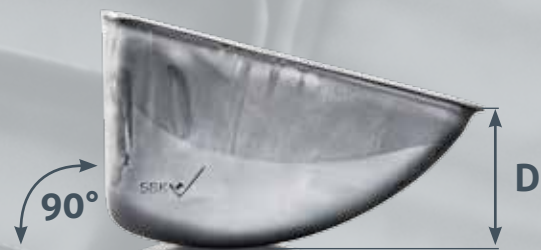
Becherhöhe - Vorne Halten Sie den Elevatorbecher an eine senkrechte Fläche und messen Sie parallel dazu vom Boden bis zur Becherkante die vordere Höhe
