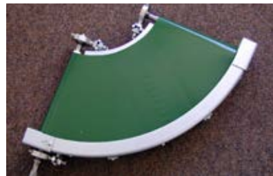
Kurvenband mit verschiedene Steuerungsmethoden - entweder über spezielle Kantenprofile, Kugellagern oder "Knöpfe".
