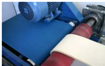
Spezielle Beschichtungen aus verschiedenen Materialien angeboten - zB. Linatex, Correx, Moosgummi, Zellkautschuk, Naturkautschuk, Elastomer weiche PU-und Weich-PVC.
